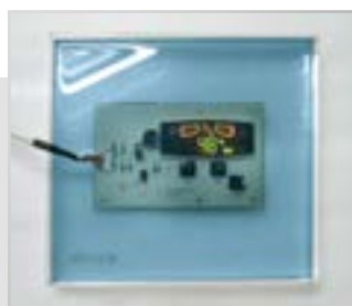
Влагостойкий контроллер со встроенным гигростатом
